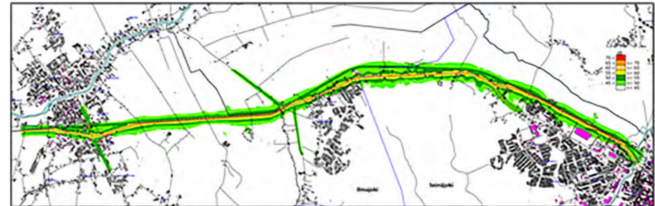
Kuva 14-2. Yöajan melu L_{Aeq,22-7} nykytilassa. Tumman vihreästä väristä alkaen ylittyy olemassa olevien asuinalueiden sekä hoitolaitosten ohjearvo 50 dB ja vaalean vihreästä uusien alueiden ohjearvo 45 dB.
